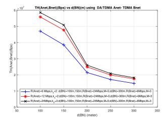
Figure 14:  $TH_{\rm Anet,Bnet}(\rm bit/s)$  vs  $d_{\rm BN}$  (m) using DA/TDMA-TDMA with  $P \ge 0.95$  ( $D_{\rm P} \le 50\,\rm ms$ ) and  $PDR \ge 0.95$
